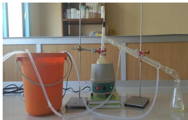
**Gambar 4.** Proses isolasi minyak atsiri jahe dengan metode destilasi air
